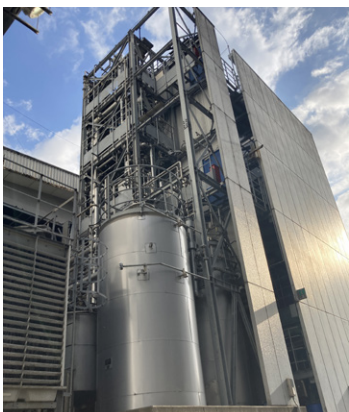
溶剤のクローズドリサイクルが行われている施設(蒸留塔)
